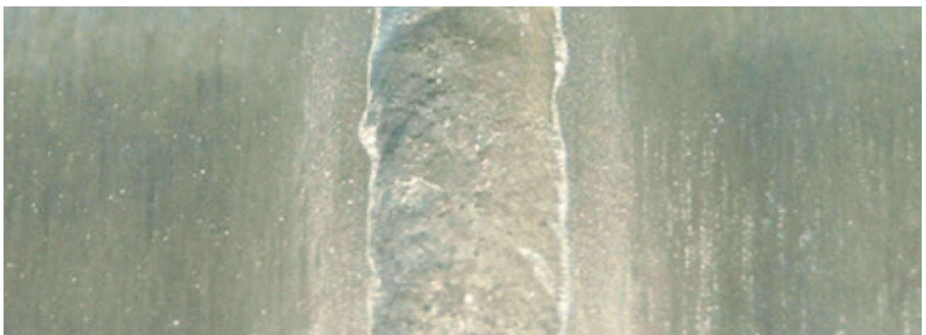
Abbildung: Schweißnaht mit WEZ nach dem Beizen
