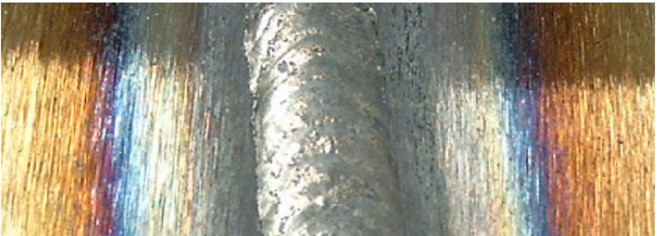
Abbildung: Schweißnaht mit angelaufener WEZ
