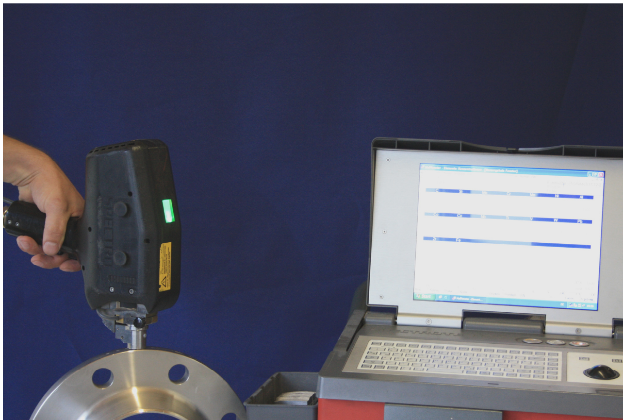
Abbildung: Materialverwechslungsprüfung zum Beispiel im Wareneingang
